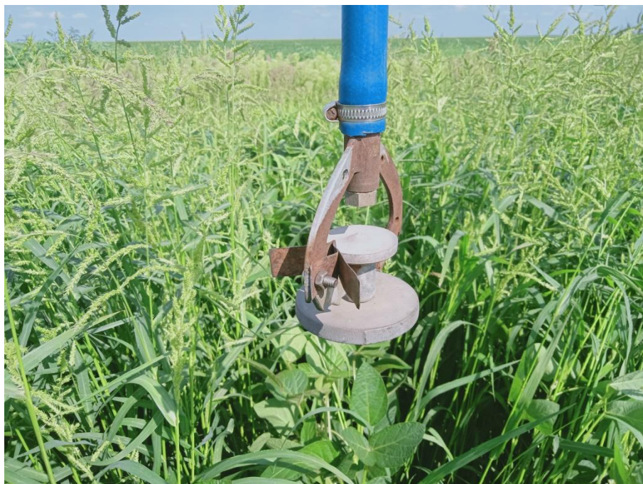
Рисунок 4.19 – Монтаж на ножке насадки клина для обеспечения секторного полива
