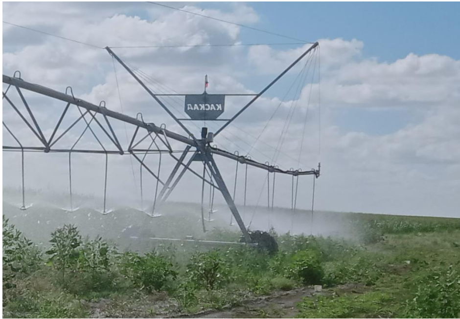
Рисунок 5.13 – ДМ с подкачивающим насосом, смонтированным на последней тележке для увеличения напора перед концевым аппаратом
