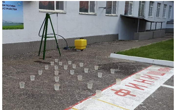
Рисунок 3.5 – Схема расстановки дождемеров по радиусам с центральными углами 5...30^{\circ} для определения распределения дождя при поливе
