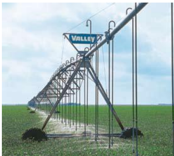
Рисунок 1.8 – Дождевальная машина «Valley» с высотой установок дождевальных насадок 0,6 м от поверхности почвы
