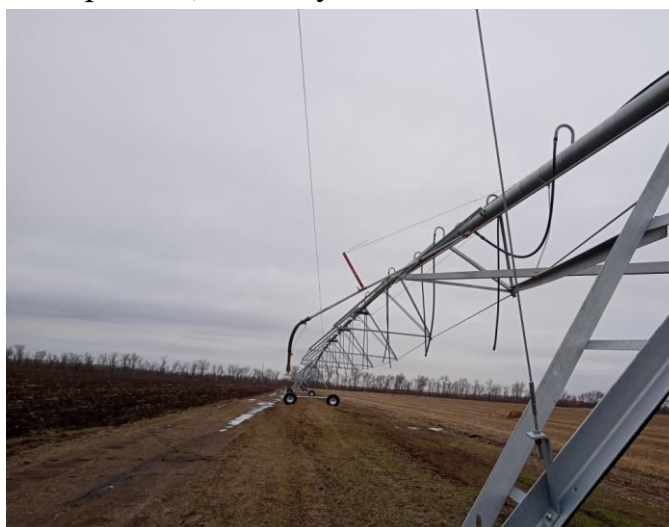
Рисунок 2.12 – Монтаж устройства приповерхностного дождевания в центральной части пролет (высота установки насадки 1,5 м и 2,5 м)
