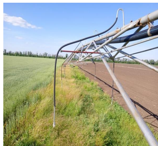
Рисунок 2.12 – Монтаж устройства приповерхностного дождевания в центральной части пролет (высота установки насадки 1,5 м и 2,5 м)
