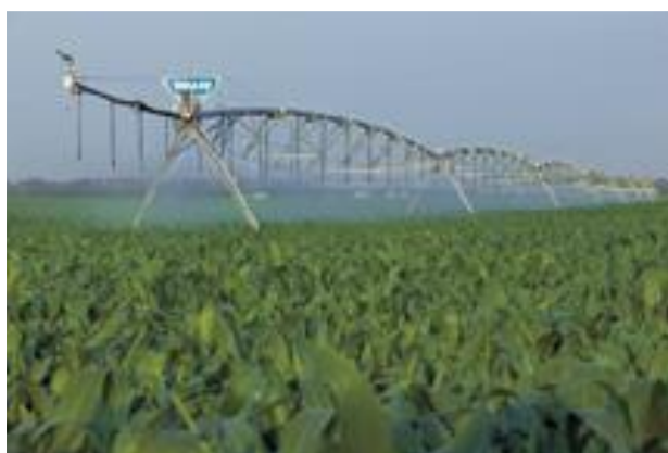
Рисунок 1.7 – Дождевальная машина «Valley» с высотой установок дождевальных насадок 2 м от поверхности почвы
