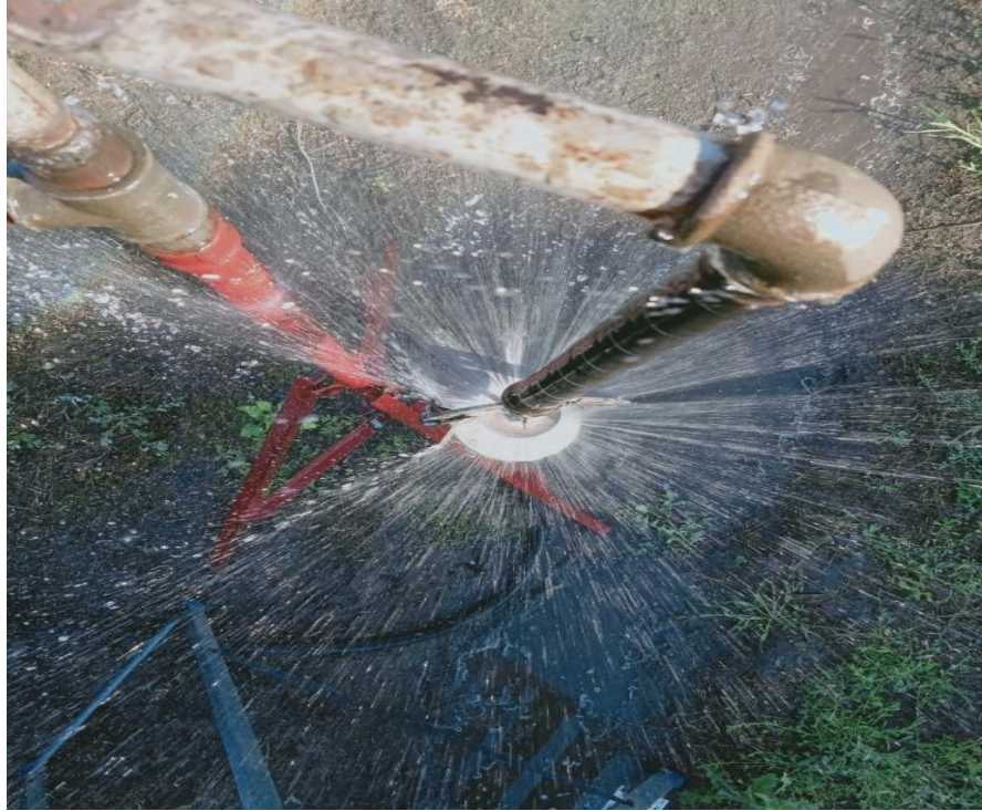
Рисунок 4.21 – Испытания дождевальной насадки секторного полива
