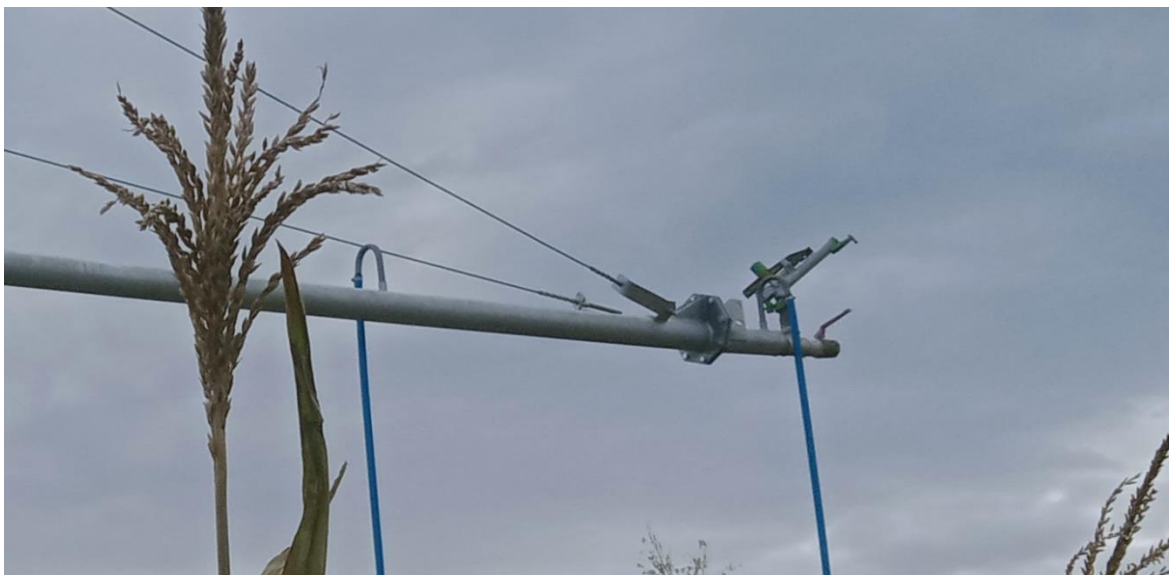
Рисунок 5.12 – Концевой дождевальный аппарат R25S на ДМ «Каскад» в ООО «Листеко»
