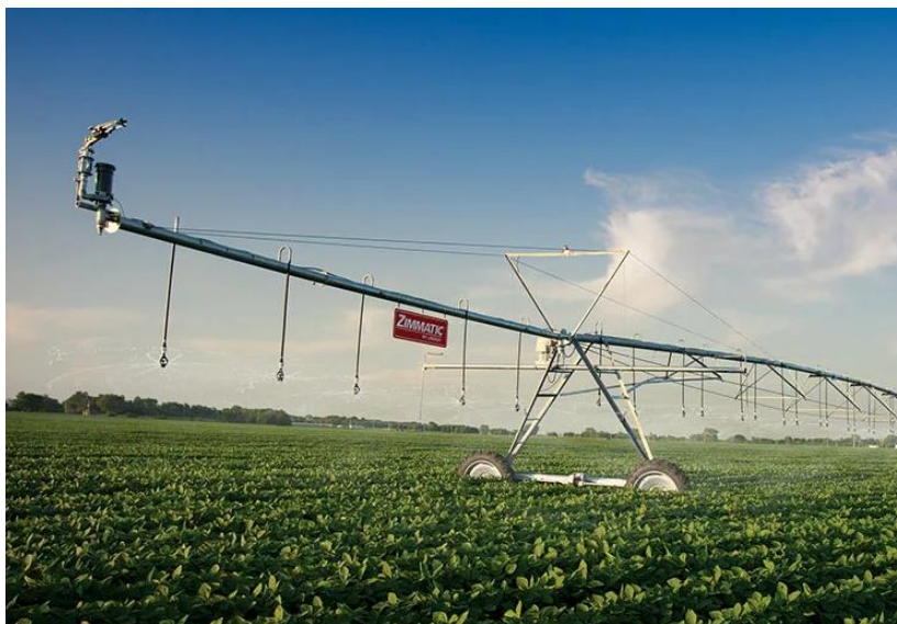
Рисунок 1.22 – Дождевальная машина Zimmatic с подкачивающим насосом перед концевым дождевальным аппаратом
