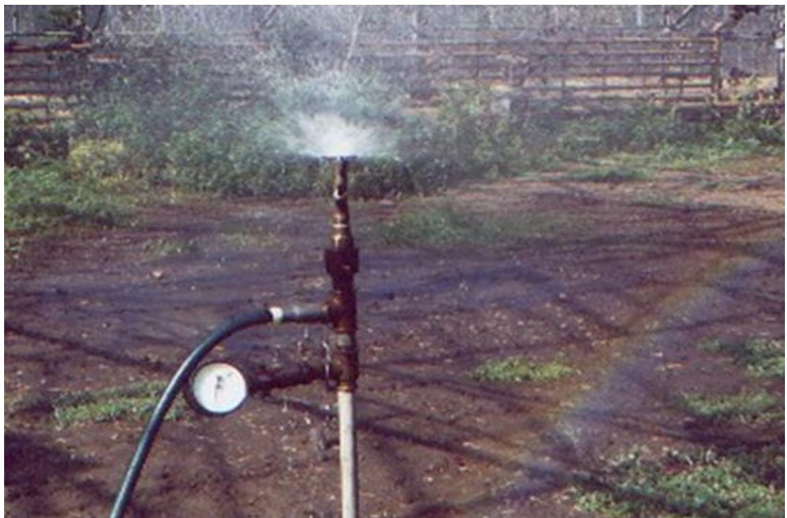
Рисунок 4.25 – Полив струйной насадкой с отражательной пластиной
