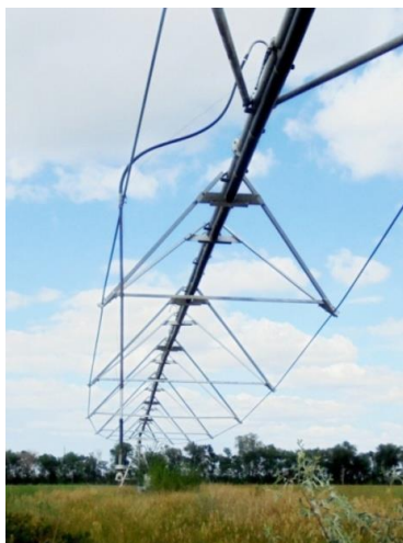
Рисунок 2.12 – Монтаж устройства приповерхностного дождевания в центральной части пролет (высота установки насадки 1,5 м и 2,5 м)
